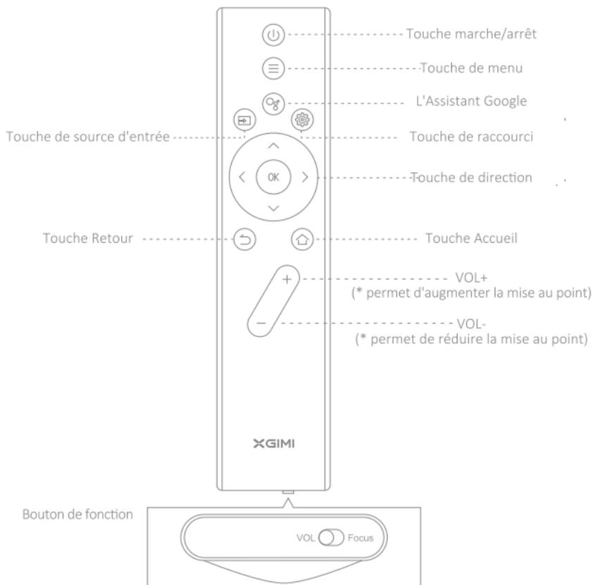
\* Pour régler le volume, il faut appuyer sur la touche d'addition/soustraction lorsque le bouton de fonction est déplacé vers la gauche (VOL).
